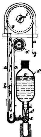
2. Apparat zur Ausübung des Verfahrens nach Anspruch 1, dadurch gekennzeichnet, daß der Reagensflüssigkeitsbehälter b mittels einer Leitung c mit einem Behälter d für einen Reagensflüssigkeitsvorrat kommuniziert und von diesem seinem Reagensverbrauch entsprechend gespeist wird.
